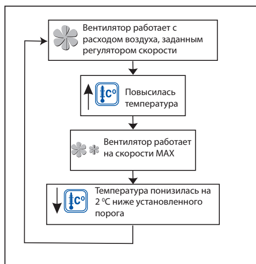
Схема работы вентиляторов Centro __ G, Centro __ G1, Centro __ G1, Centro __ G11
